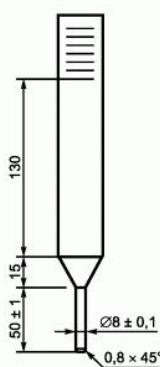
Рисунок 2 — Стальной цилиндрический штамп
